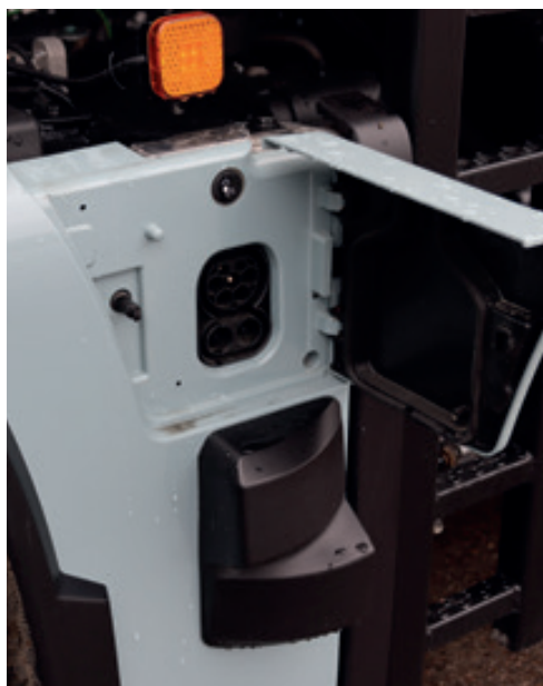
Le port de charge est installé par défaut sur le côté gauche.
