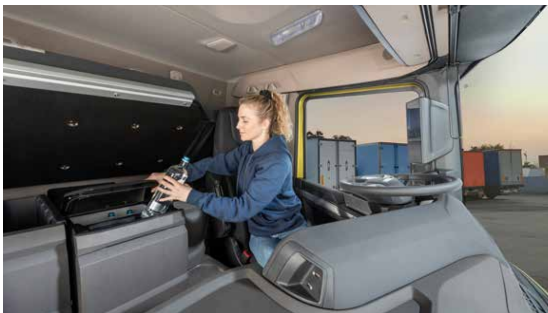
Avec un tunnel moteur moins proéminent, DAF a pu placer un frigo de taille respectable dans la cabine.
