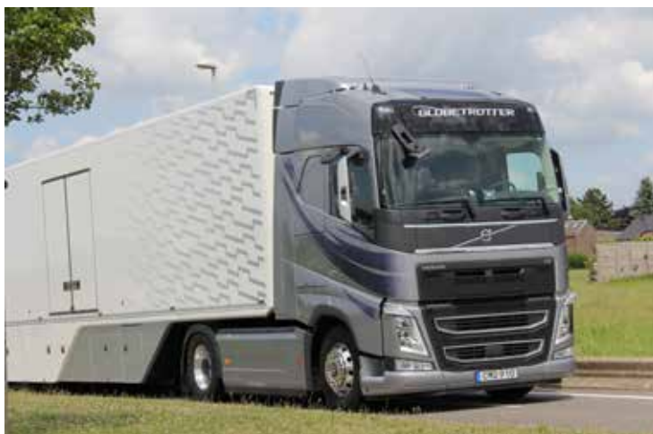
L'absence de pare-soleil est le seul élément qui permette de distinguer un FH Light Duty d'un FH normal.
