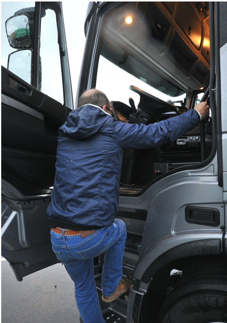
Vu la présence du tunnel moteur, seules trois marches sont à gravir.
