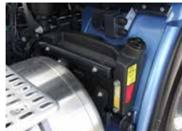
Le tout petit réservoir à diesel ne sert qu'à alimenter le chauffage de nuit.
