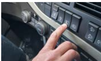
Cette nouvelle commande permet d'abaisser le châssis au-dessus de 60 km/h.
