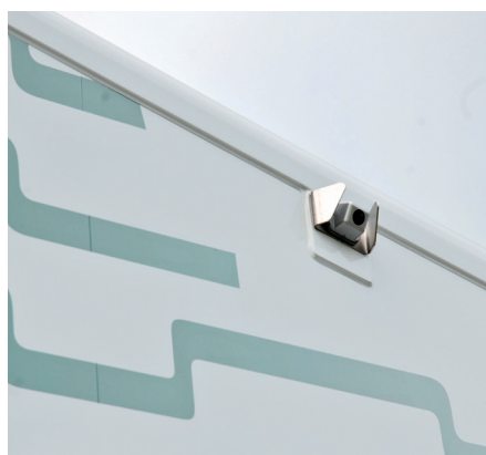
Notre véhicule d'essai était équipé d'un système de surveillance de l'angle mort à caméra, très efficace.
