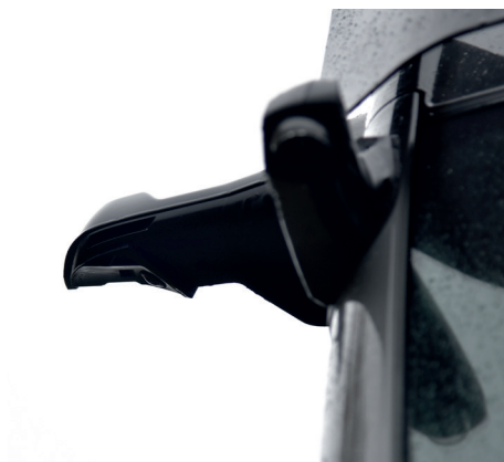
Place aux caméras en lieu et place des rétroviseurs classiques.
