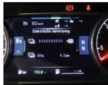
Le tableau de bord indique de manière simple l'état de charge de la batterie.
