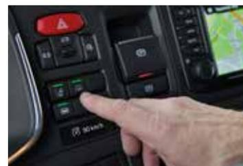
Un nouvel interrupteur apparaît sur la planche de bord pour désactiver manuellement l'assistant de maintien de voie.
