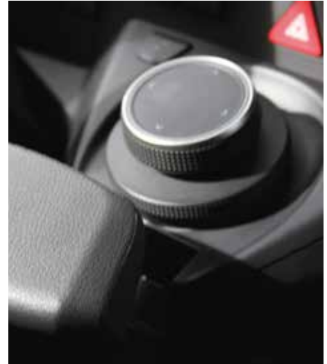
La mollette de commandes est simple et efficace. Le repose-poignet peut venir la protéger en basculant vers l'avant.
