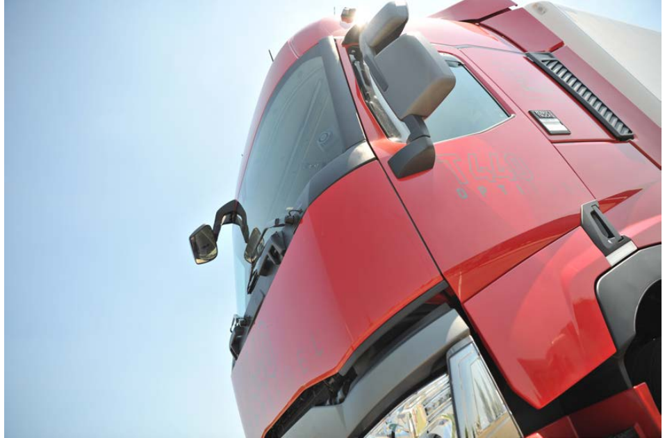
Le Renault T est le seul camion dont la cabine soit nettement plus étroite à l'avant qu'à l'arrière.
